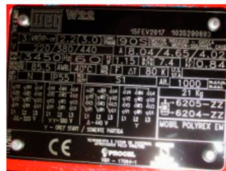
Placa de identificação do motor
